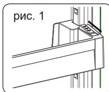
Расположите дверную полку на желаемой высоте, переместив ее вверх или вниз. После установки дверной полки в требуемое положение отпустите кнопки, расположенные по бокам дверной полки (рис. 2). Прежде чем отпустить полку, попробуйте переместить ее вверх или вниз, чтобы убедиться в надежности ее крепления.
