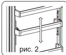
**Примечание.** Размещая продукты на подвижной дверной полке, поддерживайте ее снизу, иначе под действием веса дверная полка может выпасть из направляющих. Это может привести к повреждению дверной полки или направляющих.
